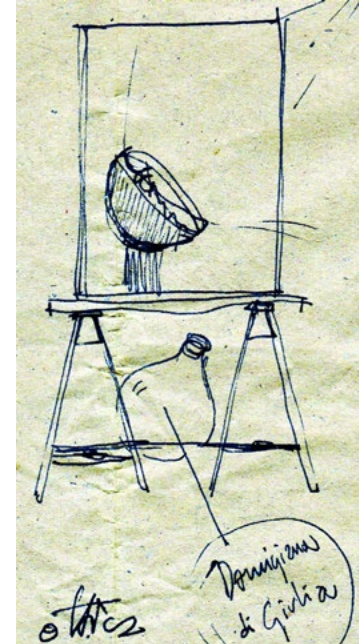
11 Marco Marzini: schizzo del principio funzionale della lampada Taccia. © Marco Marzini
