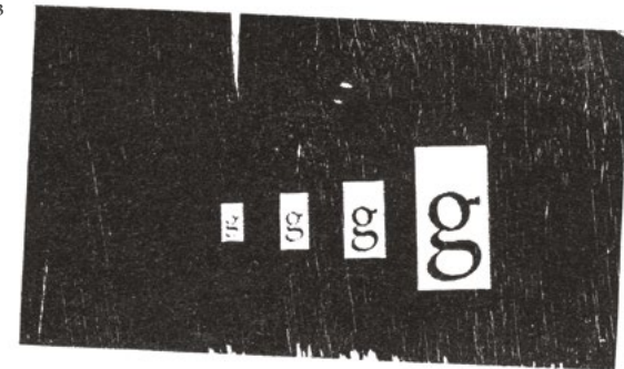
03 Caratteri in legno di pero con taglio laser. Da sx verso dx: 12 pt, 16 pt, 24 pt, 48 pt
